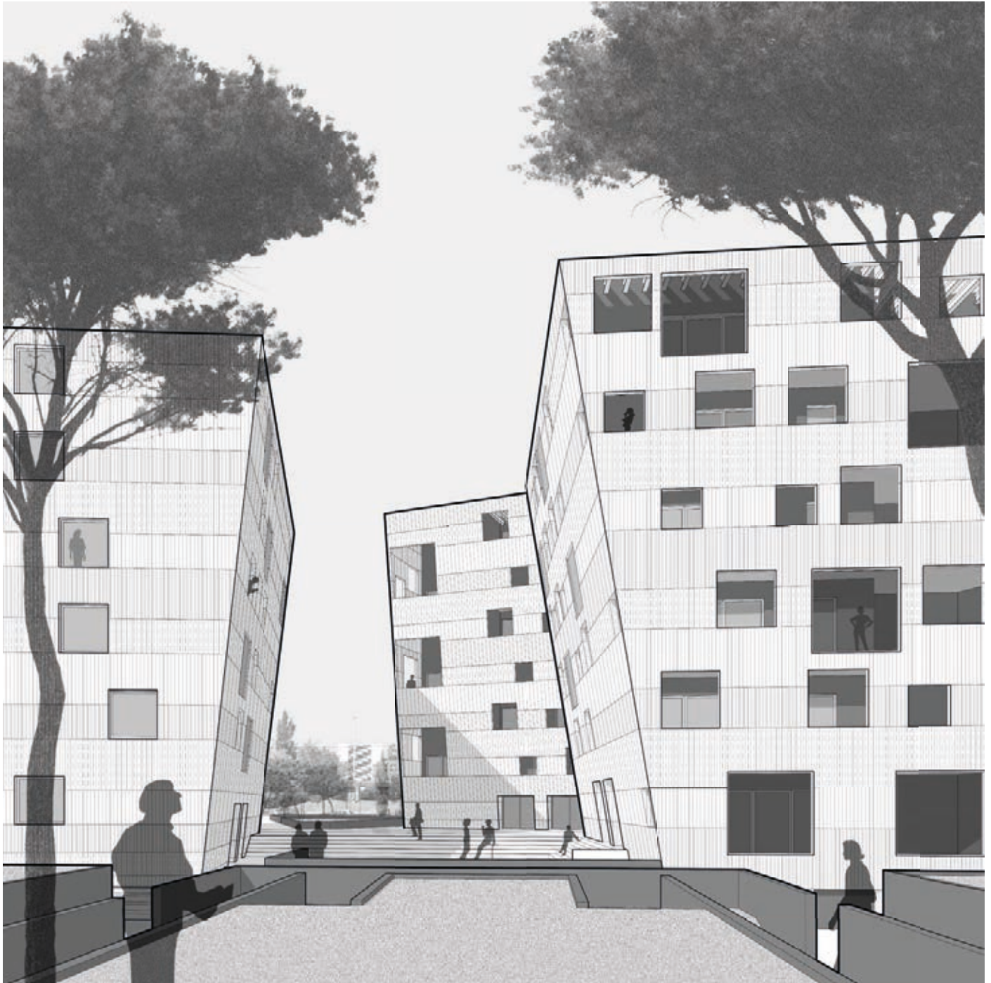
Vue de l'ensemble depuis le parc urbain qui couvre le reste de la parcelle. Les façades penchées permettent à la fois de venir créer un sens d'intimité et de clôture à la place centrale et à multiplier les ouvertures visuelles entre la triade des blocs et le reste du quartier. Ici on distingue le palais des postes de Libera au fond.
